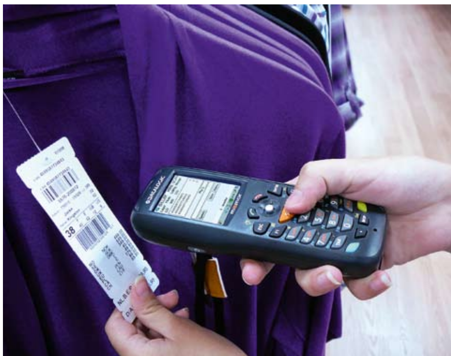
Mobile Scanner vereinfachen und beschleunigen die Inventur. Die Daten werden sofort an das Warenwirtschaftssystem übermittelt.
